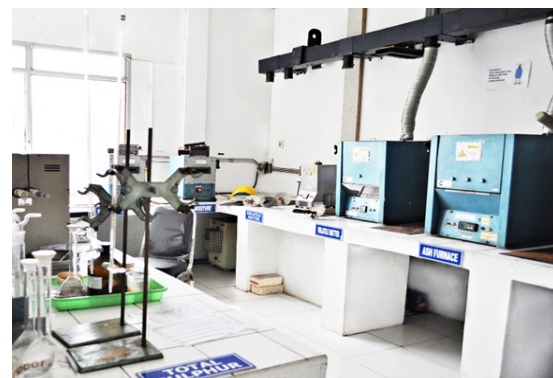
Fasilitas pengujian batubara untuk analisis proksimat
